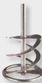
Ref. 43419 Denominación Varilla mezcladora helicoidal 2 espirales con anillo Acero galvanizado, anticorrosivo Aplicación: mezclar materiales espesos y alta viscosidad Adaptable: taladros y mezcladora eléctrica
