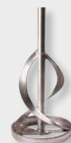
Ref. 43428 Denominación Varilla mezcladora helicoidal 2 brazos con anillo Acero galvanizado, anticorrosivo Aplicación: mezclar materiales líquidos, pinturas, barnices, etc. Adaptable: taladros y mezcladora eléctrica
