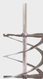
Ref. 43432 Denominación Varilla mezcladora helicoidal 2 espirales sin anillo Acero galvanizado, anticorrosivo Aplicación: mezclar materiales espesos y alta viscosidad Adaptable: taladros y mezcladora eléctrica
